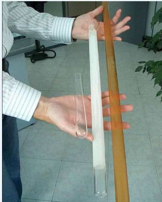
Fig.2: guaine di quarzo opacizzate rispettivamente da acque calcaree e ferruginose
